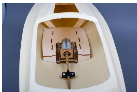
Vue: placez la propulsion dans la coque
