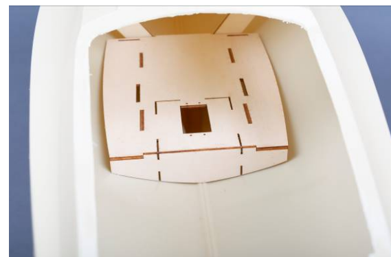
Abb. RC-Brett im Rumpf positioniert
