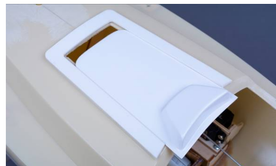
Abb. Rahmen verklebt, Schiebeluk einpassen
