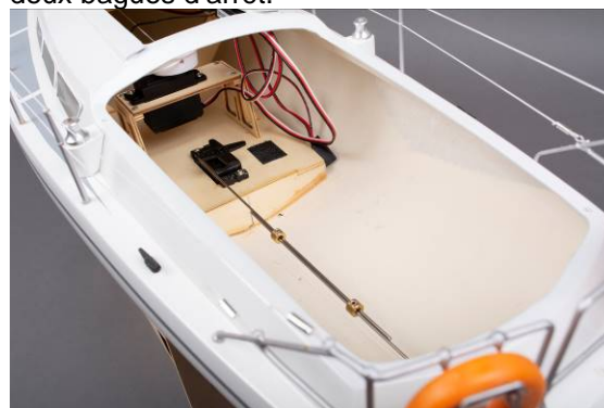
Vue: tringlerie de gouvernail
