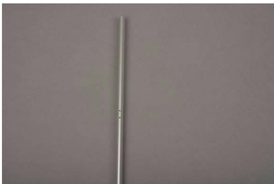
Vue: perçages pour fixation des haubans
