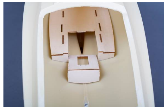
Abb. Austrennen für den Antrieb
