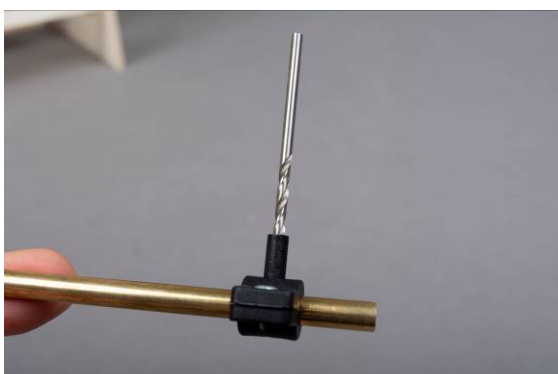
Abb. Schmierbohrung in Stevenrohr bohren
