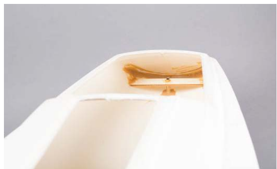
Vue: puits de gouvernail collé
