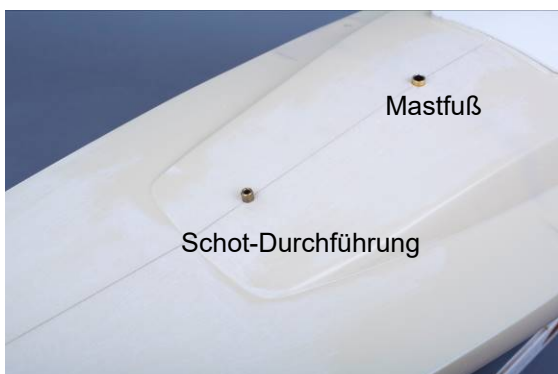
Abb. Schot-Durchführung Fockschot und Mastfuß
