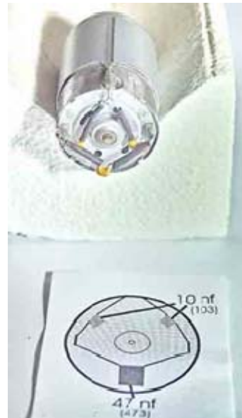
Abb. Motor entstören
